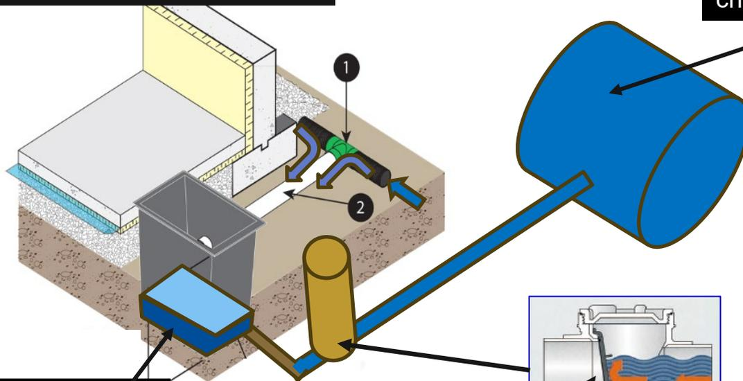
Accumulation d'eau dans le puits de pompage et évacuation de l'eau via une pompe submersible
