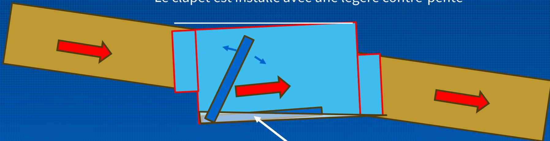
Présence d'eau et de débris (sable) empêchant le bon fonctionnement de la porte avec la rotule à la base du clapet
