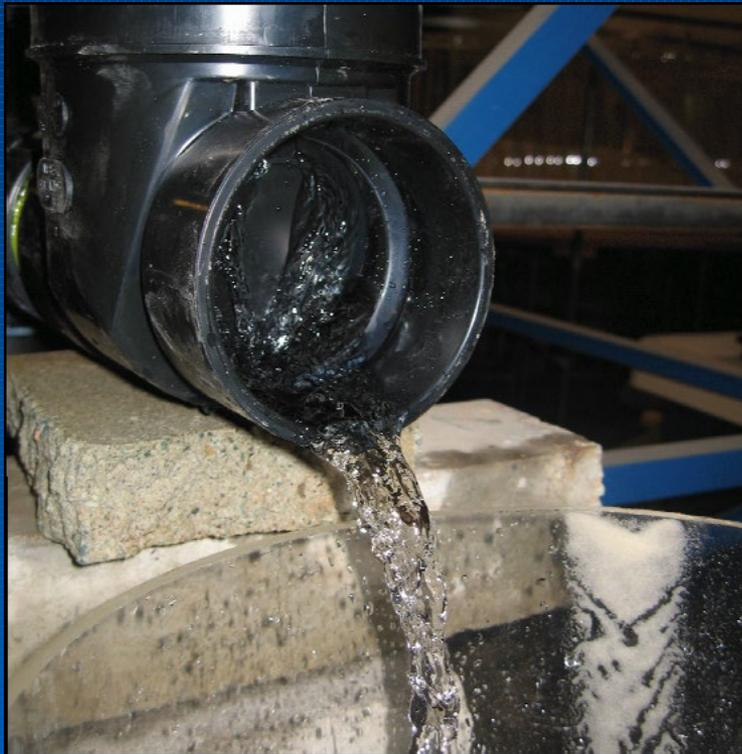
Voici le comportement intérieur d'un clapet sans joint torique sur la porte.
