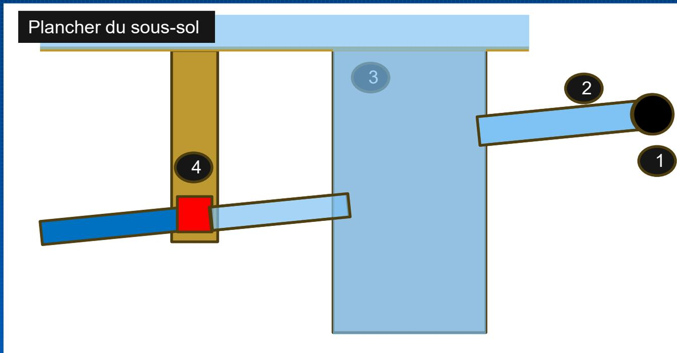
En l'absence d'une pompe, lorsque le clapet est fermé, en présence d'un réseau pluvial municipal en charge, l'eau du drain de fondation reste emprisonnée dans le puits de pompage, dans le drain de fondation, dans le gravier et sur le plancher du sous-sol.
