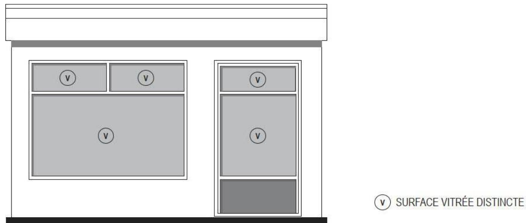
Figure 10.3 : Identification de la surface vitrée d'une fenêtre
