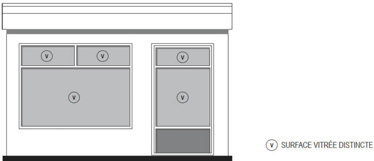
Figure 10.3 : Identification de la surface vitrée d'une fenêtre
